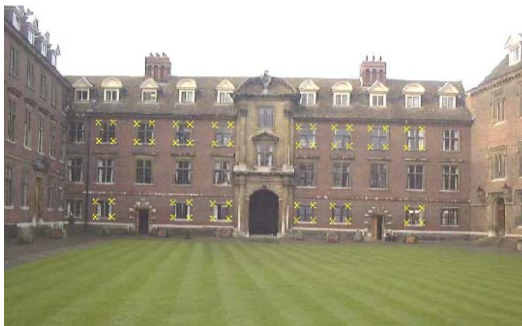
Figure 3.4. Détection d'amers plans appartenant à une façade.
