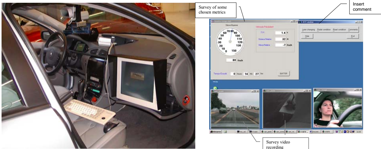
Figure 5.14. Aperçu du poste de l'ergonome et de l'affichage de plusieurs indicateurs en temps réel au cours des expériences.
