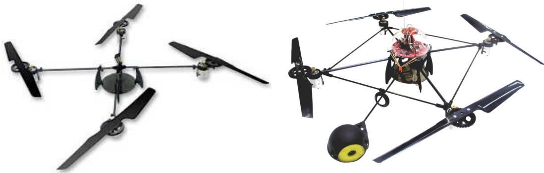
Figure 3.2 – Structure du DraganFly . Source : site DraganFly [itc]. Figure 3.3 – Structure rigidifiée du DraganFly . Source : site DraganFly [itc].
