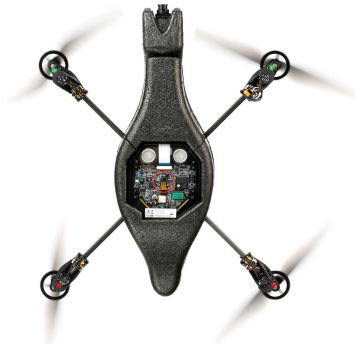
Figure 2.12 – Vue de dessous de l'AR.Drone ; la caméra verticale est repérée par un cercle rouge. Source : [idldt].
