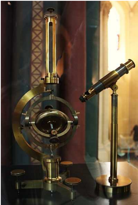
Figure 3.16 – Gyroscope inventé par Léon Foucault, et construit par Dumoulin-Froment en 1852. Source : Wikipedia [itt].
