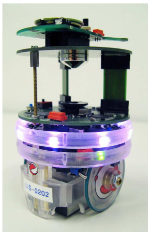
Figure 5.15 – Extension pour e-puck : caméra omnidirectionnelle. Source : [MBR + 09].
