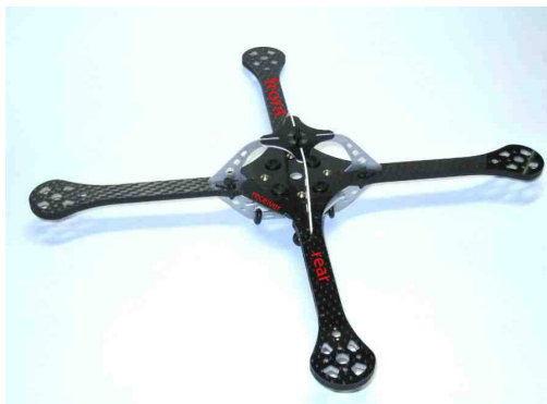
Figure 3.4 – Structure du Xufo . Source : manuel de l'utilisateur du Xufo [itv].
