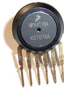
Figure 3.27 – Capteur de pression. Source : site Freescale [idtb].
