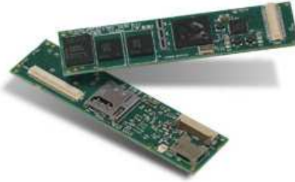
Figure 3.43 – Le Gumstix Verdex . Source : site Gumstix [ite].
