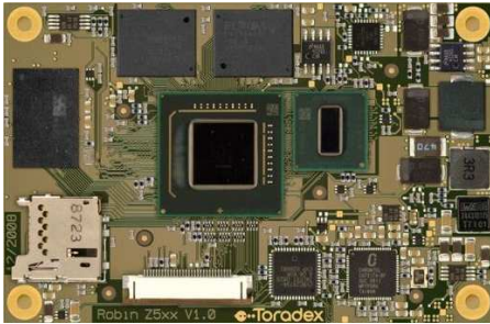
Figure 3.48 – Le module Robin . Source : site Toradex [itq].
