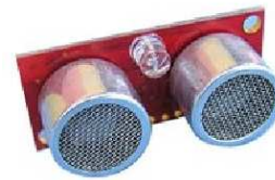
Figure 3.24 – Télémètre ultrason Devantech SRF08 . Source : site internet Robotshop [itm].
