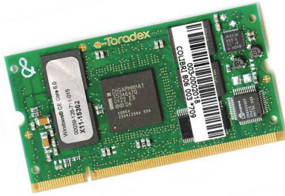
Figure 3.42 – Le module Colibri . Source : site Toradex [itq].
